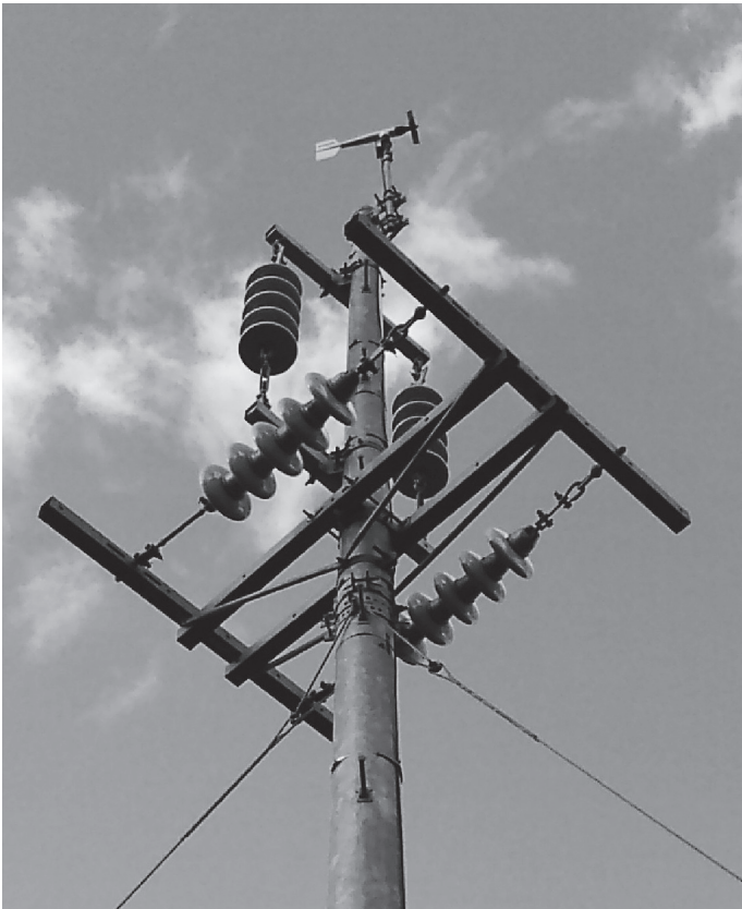
同社の汚損観測装置。吊り方を変えた懸垂端子連への付着量と汚損に関連の深い風向風速を同一個所で測定し、分析を行い気象と汚損の相関を見いだす
